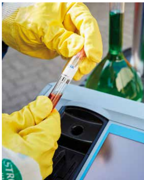
În timpul procesului de curățare sunt efectuate analize regulate. Verificăm valorile pH-ului, concentrațiile de acid, conținutul de fier, conductivitatea și inhibitorii în laboratorul mobil
